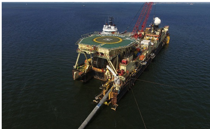
Posant des tuyaux – Le gazoduc Nord Stream 2 est posé sous la mer Baltique. (AleXeï Druzhinin/Tass/Getty Images)
